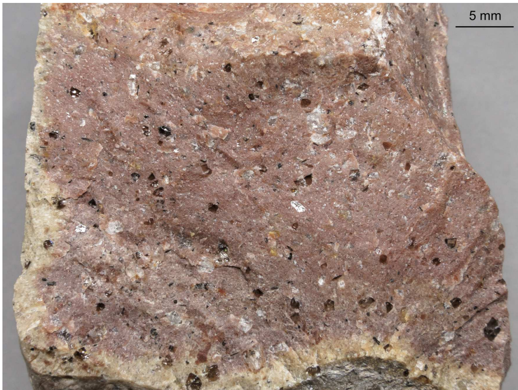
Abb. 137: Vulkanit vom Typ Dobritzer Rhyolith , mit heller (kaolinisierter) Verwitterungsrinde, grauvioletter Bruchfläche und eckigen Quarz-Einsprenglingen; Kiesgrube Horstfelde.
