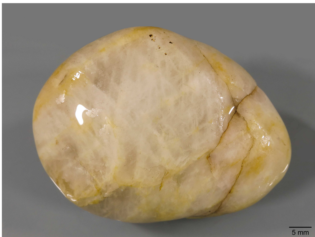
Abb. 17: Streifig durchscheinender Gangquarz vom Lindenberg bei Jühnsdorf, nass fotografiert.
