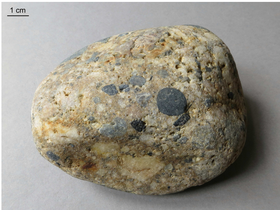
Abb. 33: Böhmisches Quarz-Lydit-Konglomerat ; gerundete Lithoklasten aus Milchquarz und blaugrauen Lyditen. Kiesgrube Damsdorf-Bochow/ Slg. D. Lüttich.
