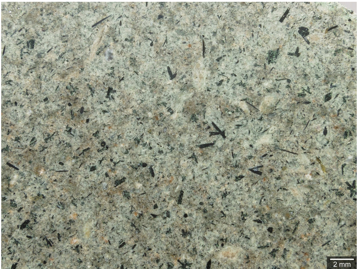
Abb. 53: Gleicher Stein, Nahaufnahme der polierten Schnittfläche: säulige Pyroxen- und nadelige Ägirin-Einsprenglinge mit undeutlich begrenzten silbergrauen Feldspat- und gelblichen bis rötlichen (alterierten) Foid-Einsprenglingen.
