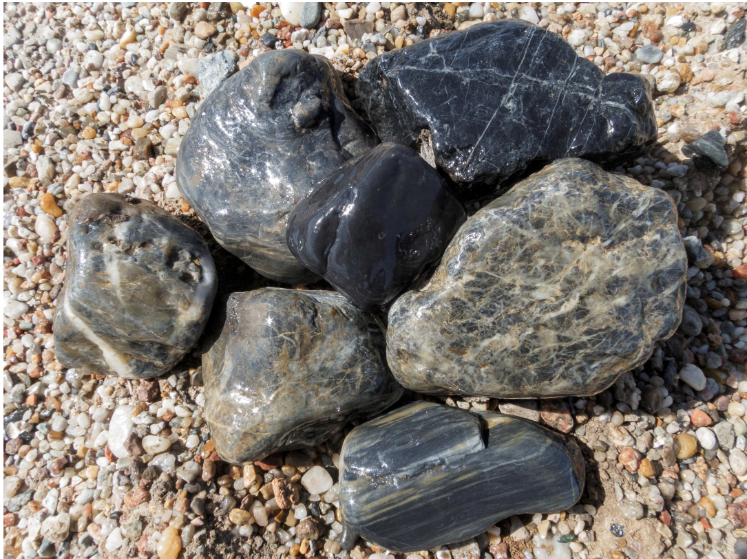
Abb. 22: Aufsammlung von Cherts/Hornsteinen in der Kiesgrube Horstfelde. Unten im Bild ein geschichteter Hornstein („Kieselschiefer“). Bildbreite 20 cm.
