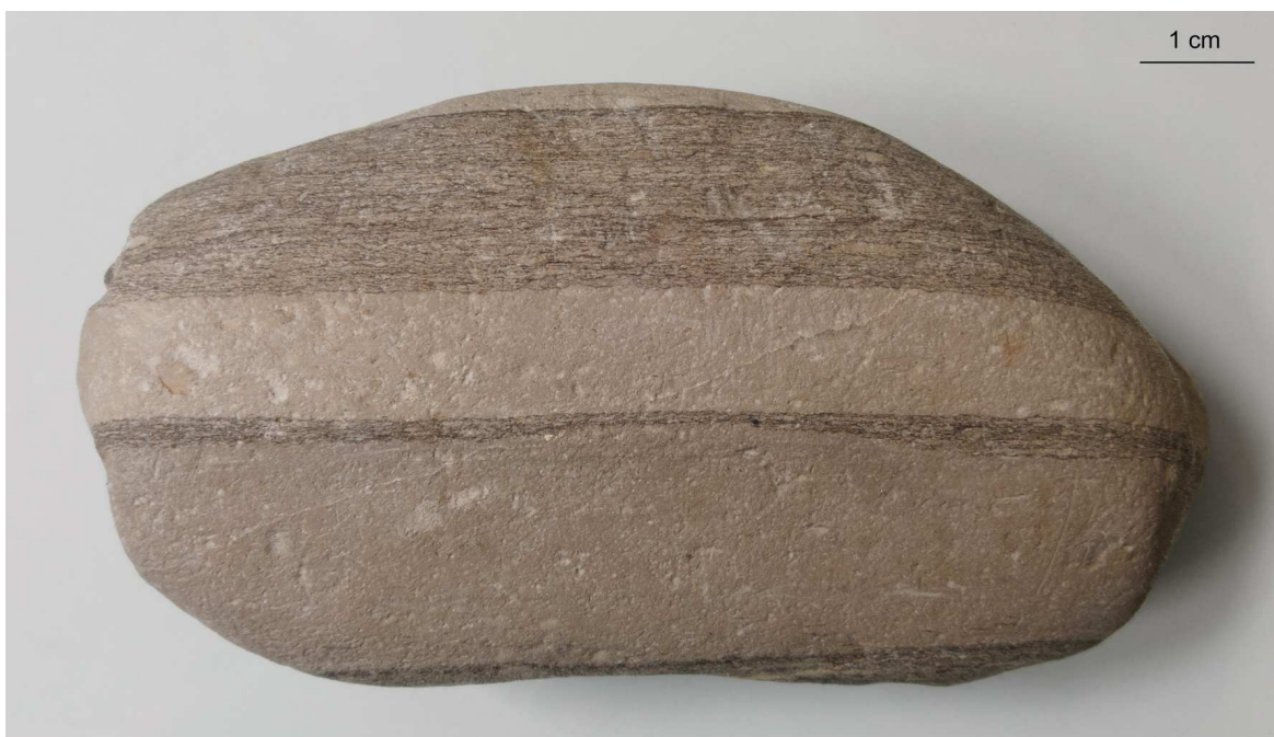
Abb. 149: Grauer Ton- bis Siltstein ( Turbidit, Grauwacke? ), mit dem Messer leicht ritzbar; hellgraue und feinsandige sowie dunklere und flaserige Wechsellagen aus tonigen und feinsandigen Schichten. Kiesgrube Horstfelde, Aufnahme unter Wasser.
