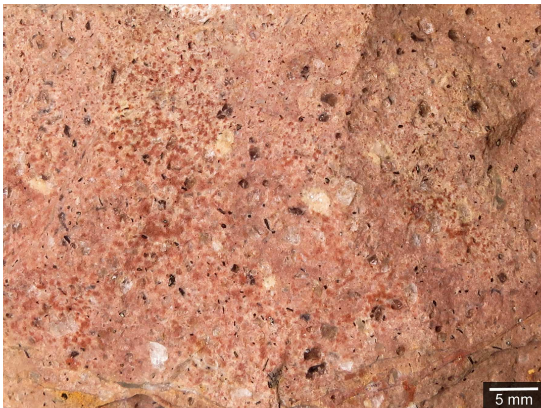
Abb. 138: Nahaufnahme unter Wasser. Die kleinen roten Flecken („Mikroachate“) sind ein charakteristisches Merkmal kaolinisierter Varianten des Dobritzer Rhyoliths (Herkunft aus dem Meißener Massiv oder Döhlener Becken).
